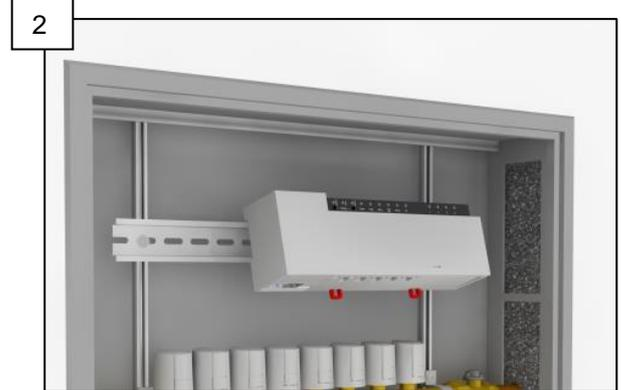
2 Basisstation leicht gekippt auf die Hutschiene aufsetzen und einrasten lassen.
